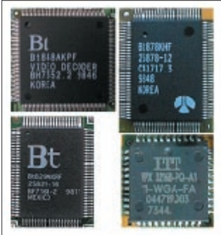
В конструкции популярных телевизионных карт чаще всего используются чипсеты Brooktree (Bi848 и Bi878 сверху и Bi829 внизу слева). Реже встречаются системы конкурентов (например Micronas IPT VPX 3216B внизу справа)
