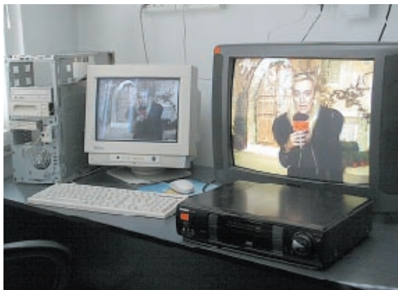
Во время теста: компьютер с установленной телевизионной картой, видеомagneфон и телевизор. Антенна подключена непосредственно к видеомagneфону, а на его выходе сигнал (высокочастотный) разделяется между картой и телевизионным приемником
