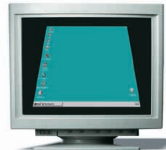
Трапециoidalное искажение: ширина изображения сверху и снизу различна
