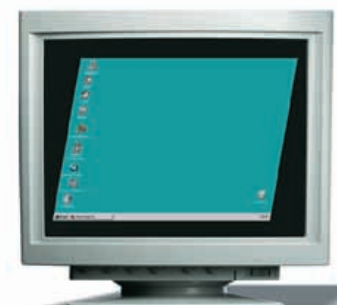
Искажение типа «параллелограмм»: края изображения имеют наклонное положение
