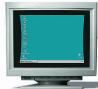
Подушкообразное или бочкообразное искажения: изображение становится уже или шире по направлению к середине экрана
